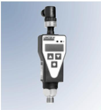
Ce pressostat est muni d'un affichage digital, de deux seuils de commutation et d'une sortie analogique. Le point de commutation est réglé au moyen de touches. Utilisation pour des pressions entre 0 et 400 bars.
